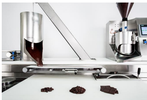
Figura 2 – Nastro di risalita, torre di concaggio e nastro di ricircolo
